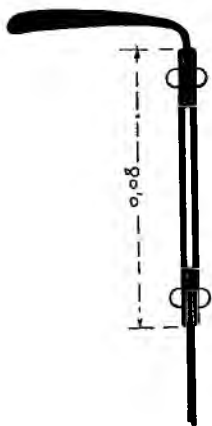
FIG. 8. (T) COUPE SUR LA BANDE D'ASSEMBLAGE FIXANT LE BORD AU CORPS DE LA CUVE.
