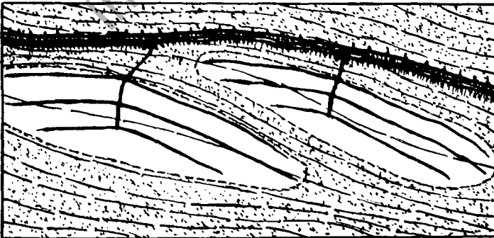
Skizze 8 Die Berieselung der Felder erfolgt durch kleine, jährliche mit dem Pflug neu gezogene Furchen, in die das Wasser durch Anstich des Hauptkanals geleitet wird
